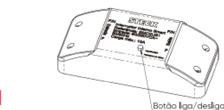
1.4. Ao ligar o módulo de interruptor interno Smarteck® na rede elétrica uma luz irá piscar a cada 2 segundos. Isso indicará que o módulo foi ligado corretamente e está funcionando.
