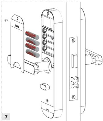
8. Finalize a instalação de acordo com o esquema da montagem da moldura da porta.
