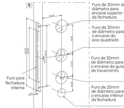
2. Encaixe a fechadura interna na porta e fixe com os parafusos C (M5X30 mm) nos locais indicados.
