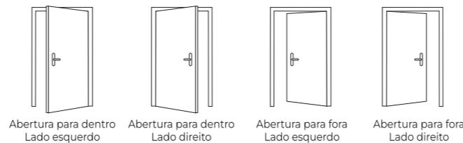
1. Escolha a direção de instalação do trinco da fechadura interna pelas direções de abertura da porta.
