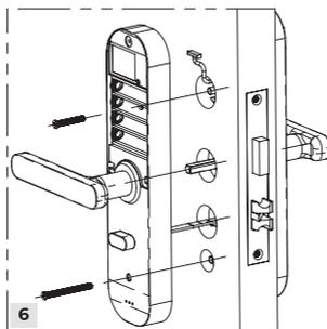
Trave os 2 parafusos nas luvas de união superior e inferior para fixação da fechadura.
