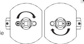
Remova o parafuso, gire a maçaneta no sentido horário a 180 graus, com cuidado e devagar. Depois de inverter a direção, fixe o parafuso novamente. Teste para verificar o movimento, não pode ficar preso. Compare a maçaneta externa com a maçaneta interna e verifique se elas têm a direção correta.
