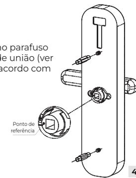
5. Alinhe o eixo quadrado com o orifício quadrado (da maçaneta) do painel interno e insira a guia de travamento no corpo da fechadura interna. Verifique o comprimento que ela terá. A guia de travamento não pode exceder a espessura da porta, portanto, verifique a medida e corte as seções de acordo com a espessura da porta.
