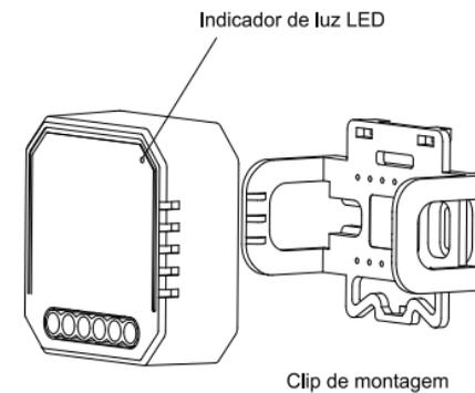
1.3. Ao ligar o módulo Smarteck® na rede elétrica, uma luz LED irá acender. Isso indicará que o módulo foi ligado corretamente e está funcionando.
